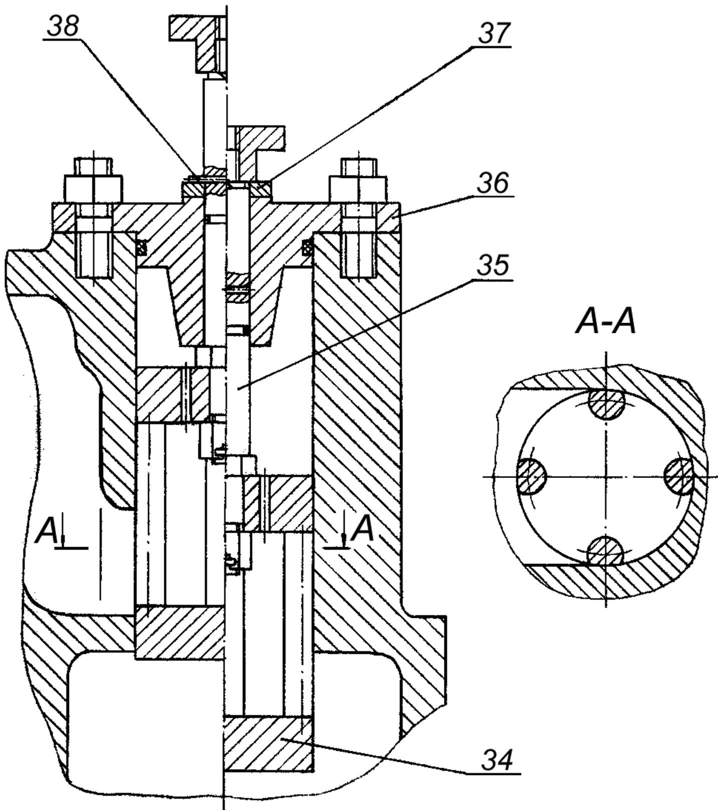
Рисунок 6 – Клапан предохранительный
