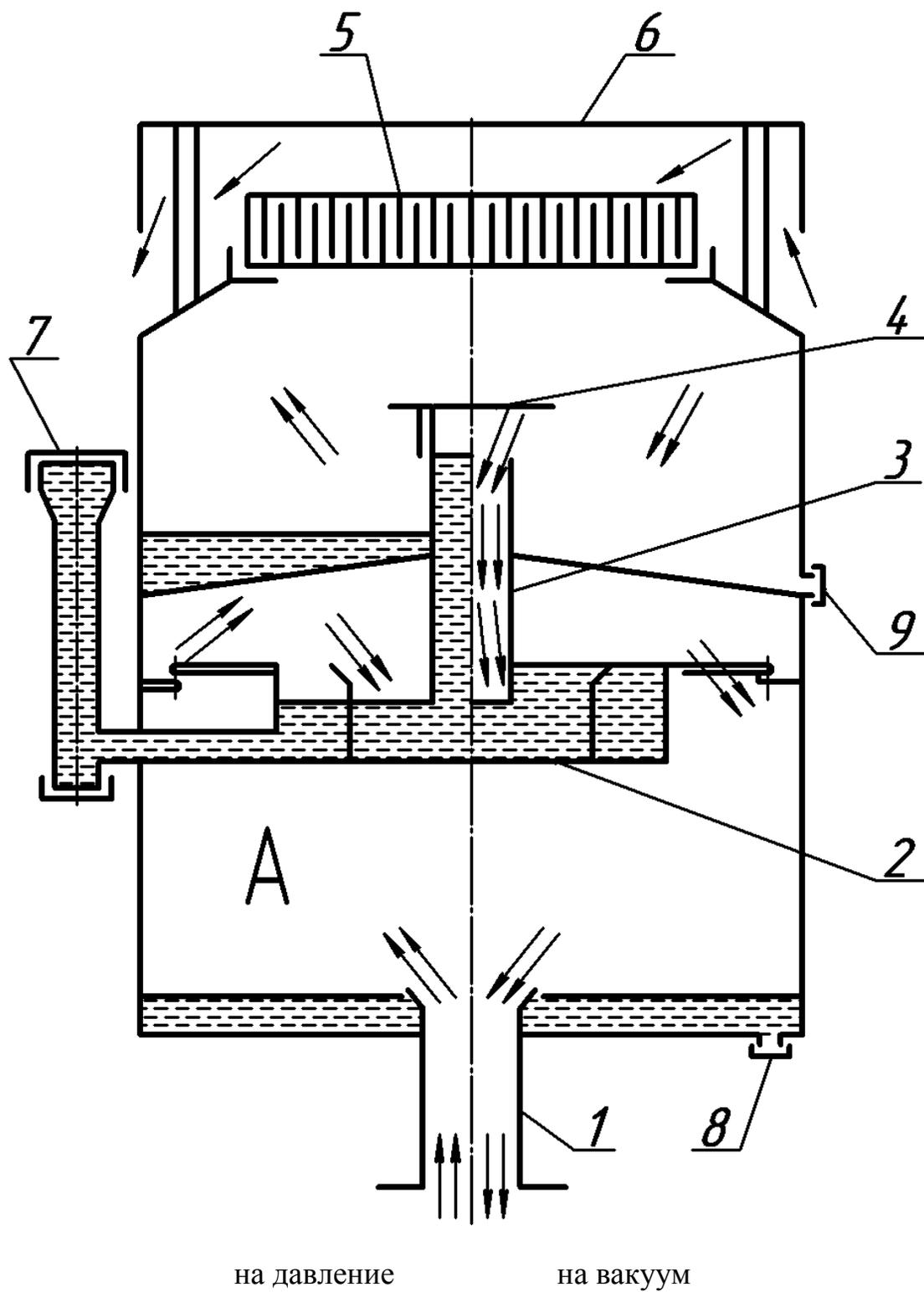
Рисунок 2 - Схема потока при работе клапана КПП
