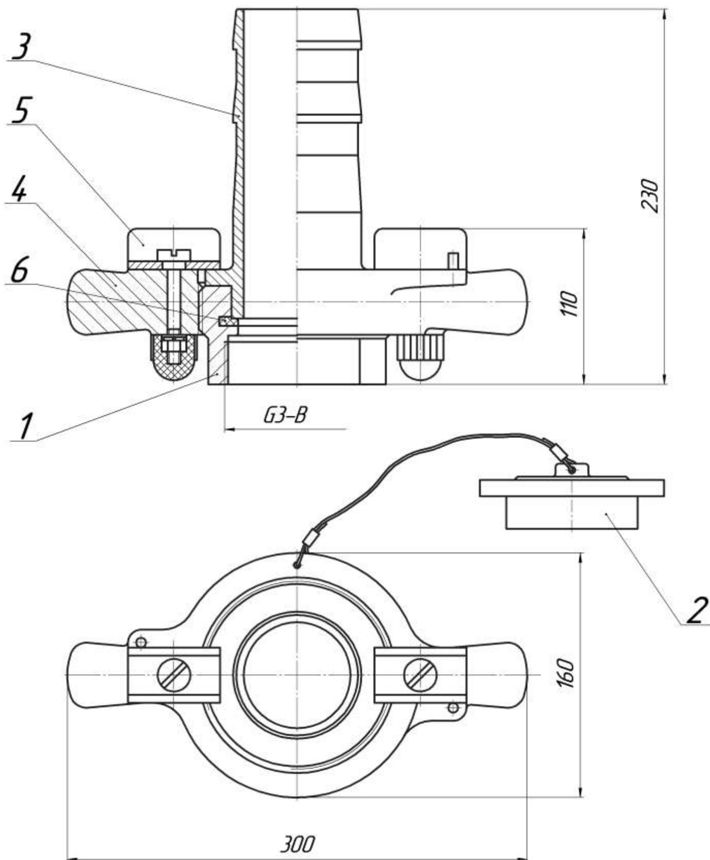
Рисунок 1 - Муфта сливная МММ
